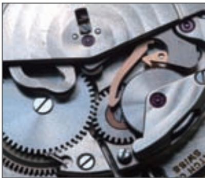
85系列的啄木鳥機芯是運用偏心的桃形齒輪來驅動兩組固定滑輪，帶動如啄木鳥嘴型的弧形鉤，產生上鍊動作。
